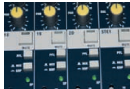
Kanalauszug: Bei Betätigung leuchtet die LED des Mute-Schalters auf.
