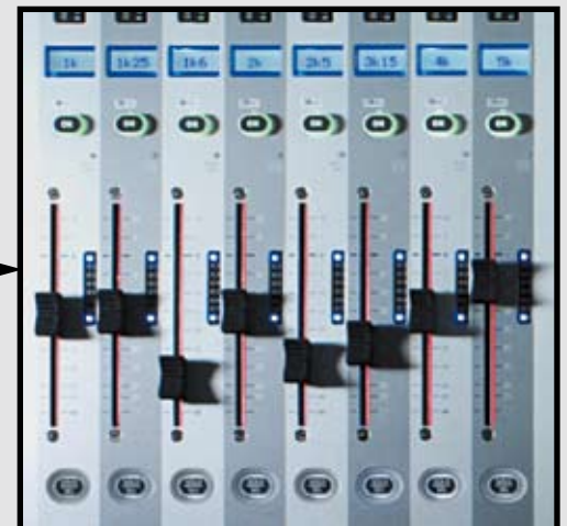
Durch einfaches Aufrufen des Ausgangsbusses und Berühren der Schaltfläche „Graphic EQ“ werden die ersten 30 Fader des Mischpults sofort dem Graphic EQ zugewiesen. Dabei wechselt die Hintergrundbeleuchtung des Soundcraft FaderGlow™ auf rot und zeigt somit an, dass die Fader nun als Graphic EQ fungieren.
